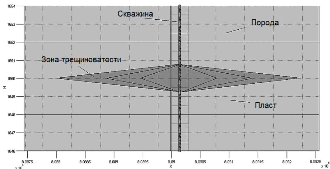
Рисунок 1.1 – Схематичный вид зоны трещиноватости в вертикальном сечении
