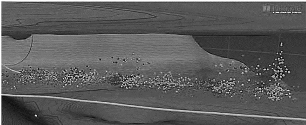
Рисунок 1.4 – Трехмерное изображение зоны трещиноватости, полученное с помощью программного обеспечения FracTrac [46]
