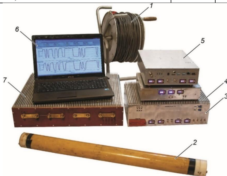
Рисунок 4.2 – Экспериментальный образец измерительного комплекса ЭРК ШПС, внешний вид: 1 – индукционная зондирующая рамка (ИЗР); 2 – индукционный датчик сигналов (ИДС); 3 – генератор зондирующих сигналов (ГЗС); 4 – устройство градуировки (УГ); 5 – блок управления и регистрации сигналов (БУРС); 6 – переносной компьютер (ПК); 7 – блок ограничения тока (БОТ).
