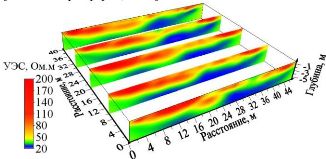
Рисунок 18 – Геоэлектрические разрезы по результатам электротомографии аппаратурой Скала-48
