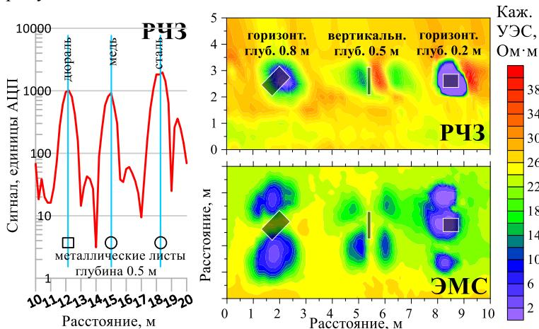
Рисунок 13 – Результаты испытаний макета аппаратуры РЧЗ на электрометрическом полигоне ИНГТ СО РАН: модуль сигнала на частоте 5 кГц по результатам исследований вдоль профиля, проходящего над тремя горизонтальными металлическими листами (слева). Карты распределения кажущегося УЭС при площадном профилировании на частоте 28 кГц над тремя медными листами (справа)
