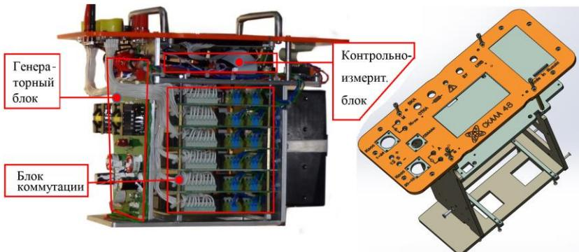
Рисунок 14 – Организация приборной панели, несущего каркаса и внутреннего пространства аппаратуры Скала-48: схема расположения основных аппаратурных блоков (слева), сборка трехмерных моделей приборной панели и несущего каркаса (справа)
