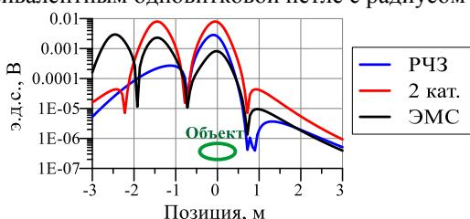
Рисунок 12 – Синтетический сигнал над локальным проводящим объектом (глубина 0,5 м) на частоте 50 кГц для малого зонда РЧЗ, двухкатушечной аппаратуры с копланарным горизонтальным расположением катушек в одной плоскости и трехкатушечной аппаратуры ЭМС
