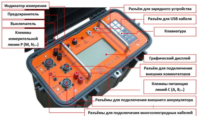
Рисунок 15 – Приборная панель, элементы управления и индикации, разъемы для подключения электроразведочных кабелей, проводов, зарядного и считывающего устройств
