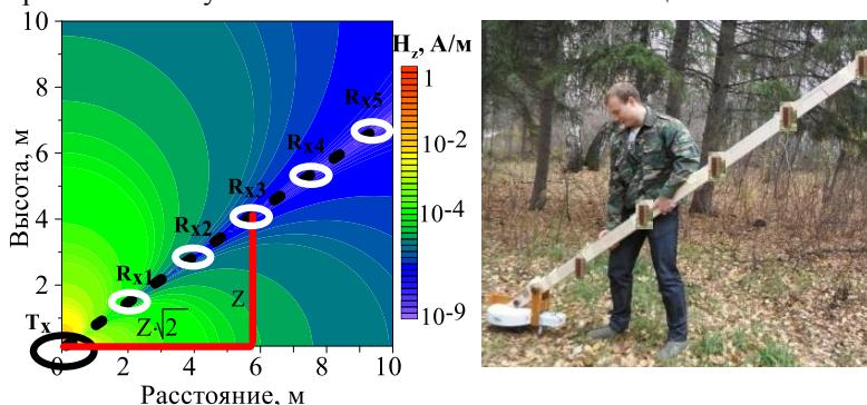
Рисунок 10 – Поле магнитного диполя, расположенного в начале координат однородного пространства с сопротивлением  $1000 \text{ Ом}\cdot\text{м}$ , схема расположения измерительных катушек вдоль линии компенсации (слева); макет аппаратуры радиально-частотного зондирования (справа)
