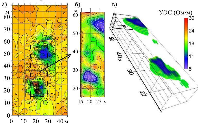
Рисунок 19 – Распределение УЭС зараженного пестицидами грунта: карта кажущих значений по результатам электромагнитного профилирования аппаратурой ЭМС (а), детализация методом ЭТ аппаратурой Скала-48 – срез на глубине 1.8 м (б), области повышенного содержания пестицидов грунта по результатам трехмерной инверсии данных методом ЭТ (в)
