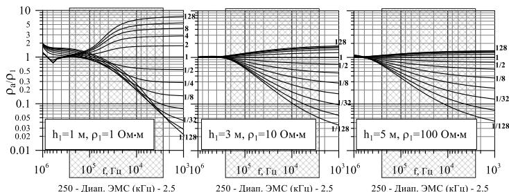
Рисунок 7 – Зависимость кажущегося относительного УЭС от частоты зондирования двухслойной среды при различных соотношениях между УЭС слоев ( $=1/128, \dots, 1/2, 1, 2, \dots, 128$ ) для фиксированных значений  $h_1$  и  $\rho_1$  по результатам численного моделирования и трансформации синтетических сигналов
