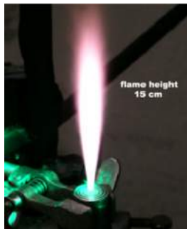
Рис.: а) пирогенный синтез наночастиц, б) микрофотографии наночастиц, полученных с помощью пламенного синтеза.
