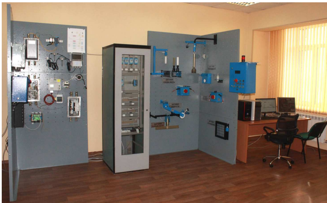
Рисунок 33. Имитационный программно-аппаратный комплекс тестирования прикладного программного обеспечения АСУ ТП
