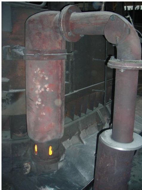
Рисунок 4.2. Щелевая горелка ванны электролизёра алюминиевого производства
