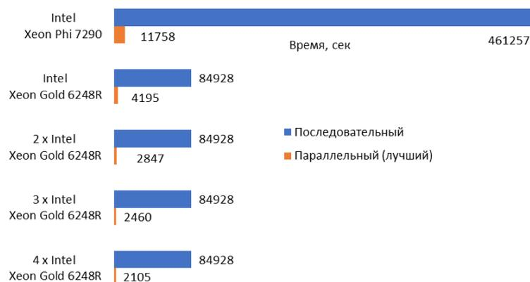
Рис. 12: Продолжительность последовательного и параллельного решения обратной задачи на различных конфигурациях кластера НКС-1П ССКЦ
