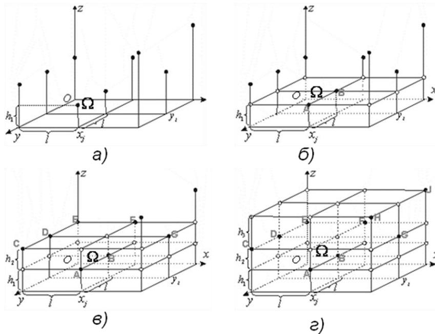
Рис. 3. Построение трёхмерной расчётной сетки
