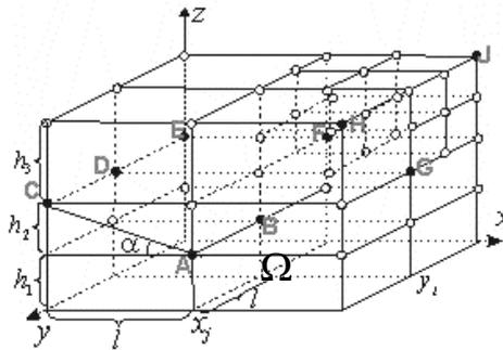
Рис. 4. Трёхмерная расчётная сетка
