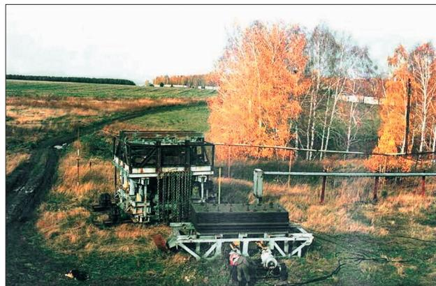
Рис. 1. Вибраторы ЦВ-40 (ближний) и ЦВ-100 на Быстровском вибросейсмическом полигоне СО РАН.
