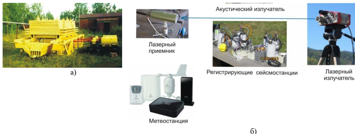
Рис.1 Компоненты акустооптической системы: а)-сейсмический вибратор ЦВ-40; б)акусто-оптический стенд
