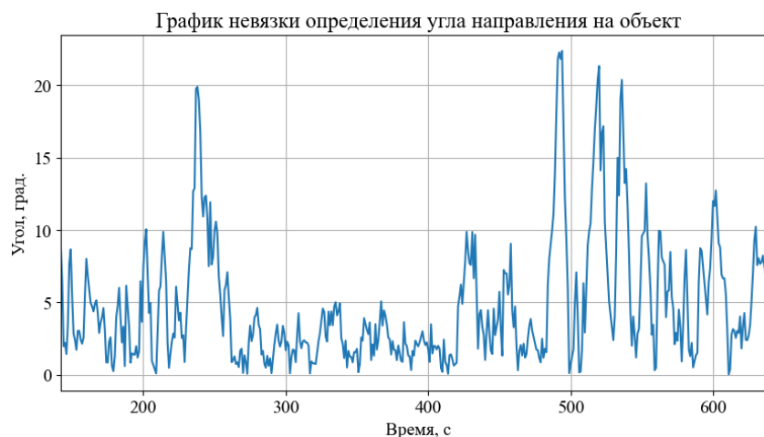
Рис. 8. График изменения модуля невязки определения угла поляризационным методом на исследуемом участке движения объекта, регистрируемого станцией № 59
