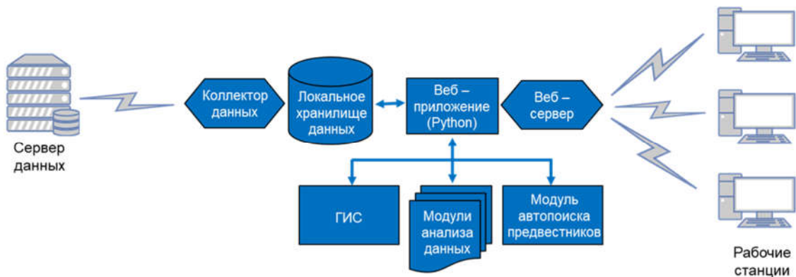
Рис. 10: Цифровая платформа для комплексного геофизического мониторинга
