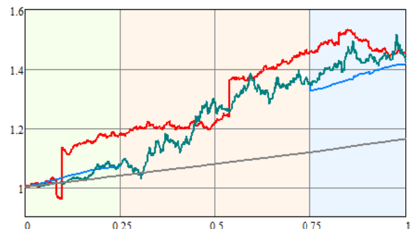
Рис. 4 – Траектория объекта наблюдения (красная линия); результаты фильтрации (зеленая линия); интерполяции (для t из [0, 0.25] синяя линия); экстраполяции (для t из [0.75, 1] синяя линия); математическое ожидание (серая линия)
