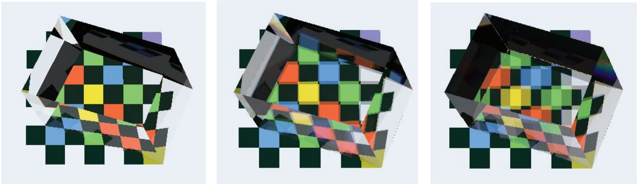
Рис. 10: Шестигранники с оптическими характеристиками (слева направо): изотропного, одноосного и двuosного кристаллов
