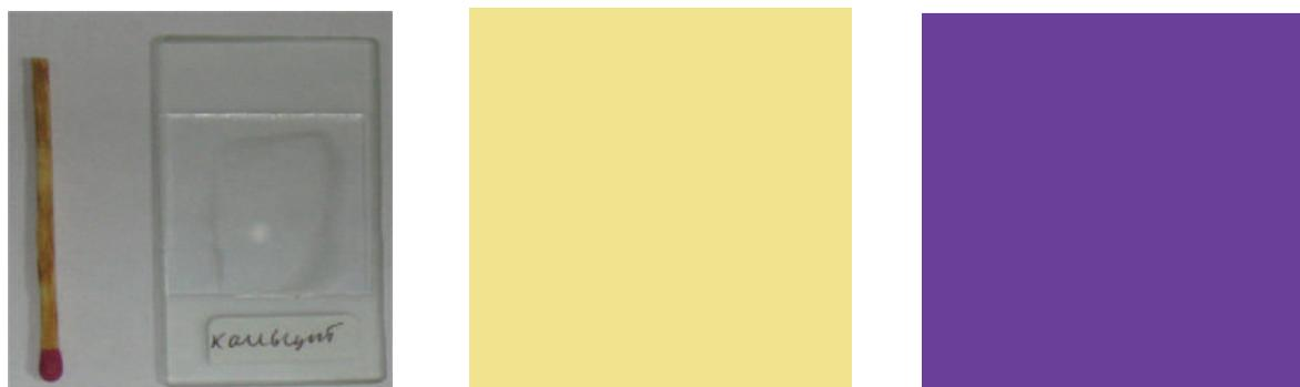
Рис. 4. Фото пластинки-шлифа кальцита (на бумаге около спички) и ортоскопические интерференционные картины для разных толщин шлифа. Полярископ позволяет видеть цветную интерференционную картину для прозрачного в обычной обстановке образца
