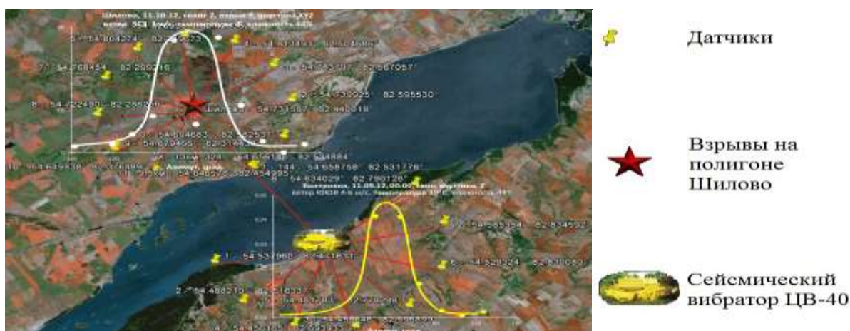
Рис. 1. Схема регистрация сейсмоакустических колебаний от сейсмического вибратора ЦВ-40 и взрывов (полигон Шилово). Графики ветровой зависимости уровней инфразвука обоих источников от азимутальных направлений, характеризующие узконаправленную концентрацию акустической энергии в пространстве.
