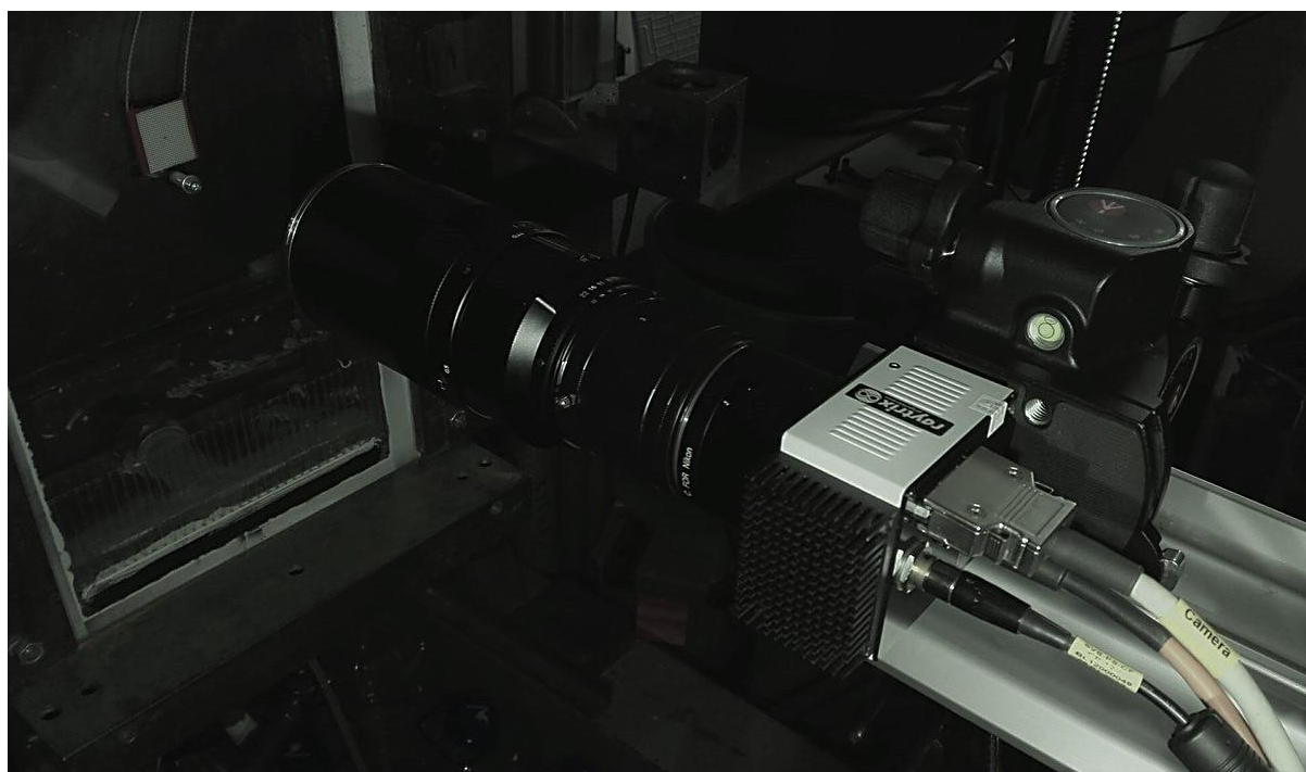
Рисунок 26 — Фотография тестового участка и оборудования для измерения поля скоростей в следе за цилиндром камерой светового поля во время калибровки системы. Калибровочная мишень расположена в области над цилиндром.
