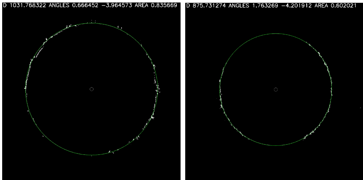
Рисунок 24 — Пример экстраполяции окружностью выходного (слева) и критического (справа) сечений ГТД. Белые точки – исходные данные, зелёная окружность – результат работы алгоритма RANSAC.
