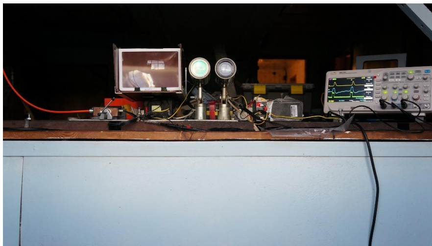
Рис. 19. Приемный стенд с оптоэлектронными и волоконным приемниками и многоканальным осциллографом в лабораторном корпусе
