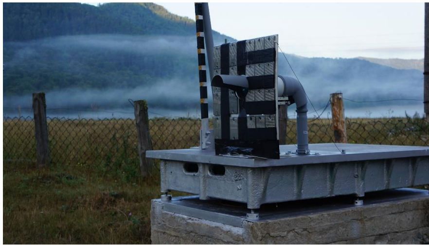
Рис. 18. Стенд с линзо-волоконной линией и сегментированными отражателями на внешнем постаменте
