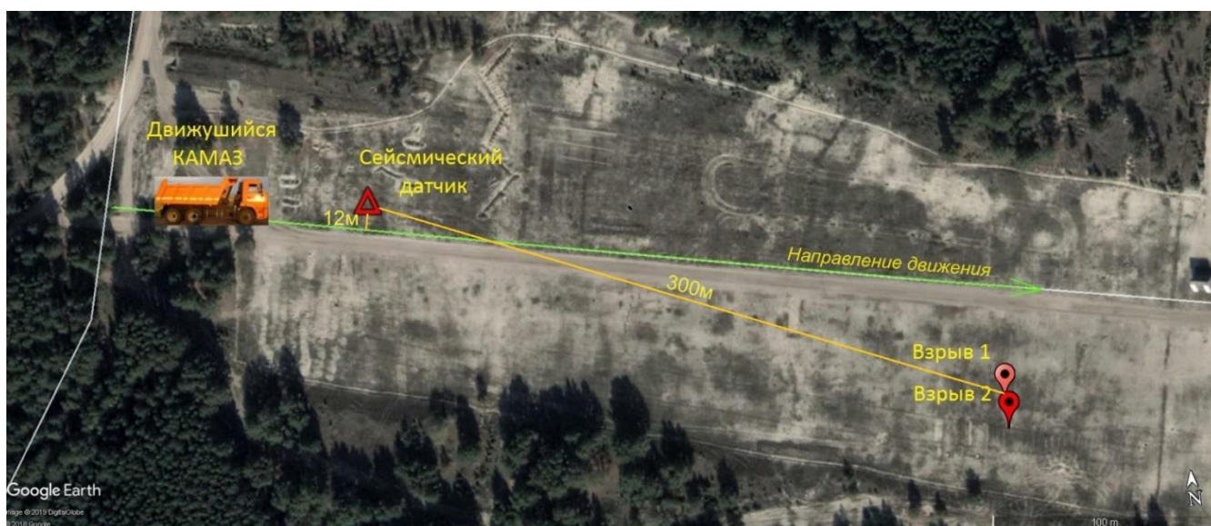
Рис.5. Схема движения тяжелого КАМАЗа и расположения сейсмической станции и мест проведения 2-х взрывов.
