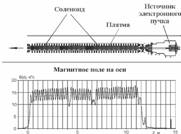
Рис.4. Многопробочная ловушка с источником пучка и распределение магнитного поля на оси
